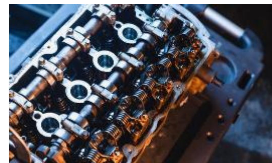
Hliníková hlava bloku válců
